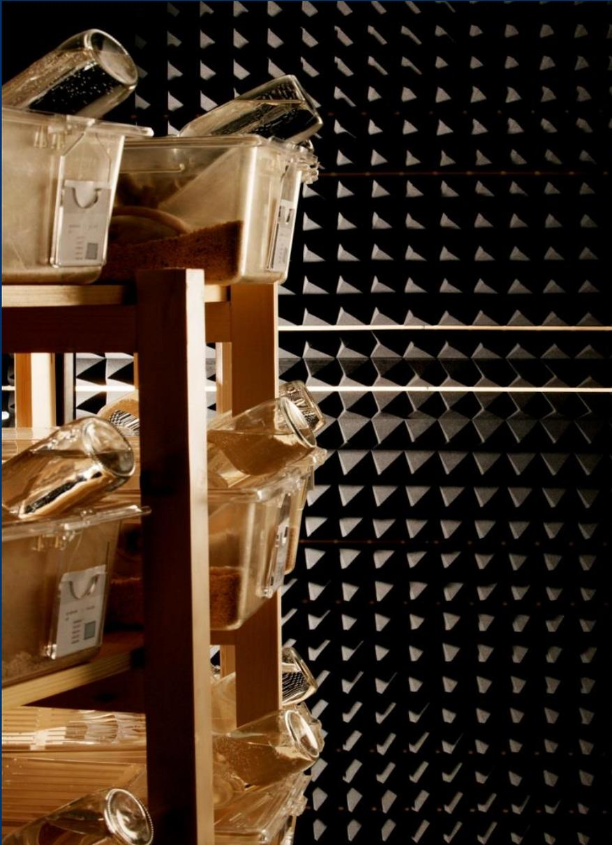
Le camere di esposizione sono state completamente schermate per minimizzare l'effetto di disuniformità dovute a riflessioni e conseguenti interferenze causate dalle pareti.
